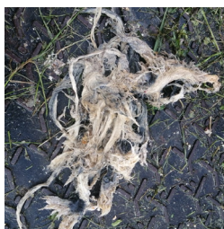
Takto vypadají vlhčené ubrousky po odstranění z řezacích částí ucpaného čerpadla
